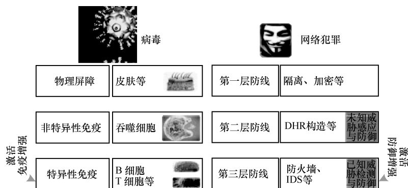
图 2 生物免疫启发下的一种内生安全三层防御技术框架示意图
